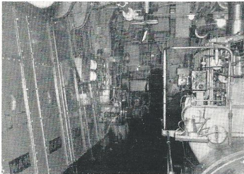
1. Babord side på maskindørken. Man ser Hovedmotorens manøvrerplass og en av hjelpemotorene.
