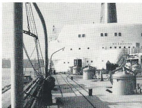
Akterdekk med tankluker — fallreppstrapp.
