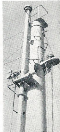
Stomp formast med hydraulisk drevet sirene.
