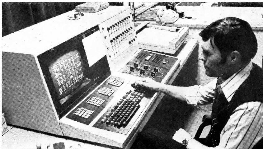
Instruktør, skipsfører Johan T. Vespestad, Bømblo, overvåker manøvreringen og har mange knapper som brukes til å skape uforutsette vanskeligheter for elevene i styrhuset på den andre siden av veggen.
