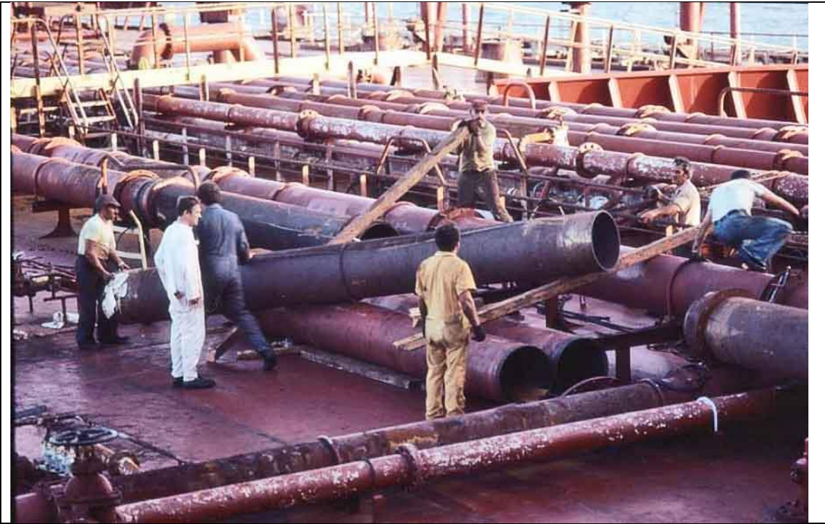
SFJ00119790138103 Jarita, utskifting av rør. Auno inspiserer (foto: Per Sundfær)
