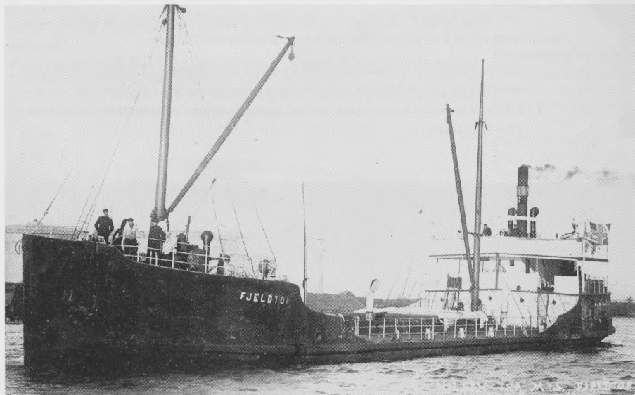
Motorfartyget FJELDTOP var byggt av armerad betong. Här på ett foto från Stettin taget av Max Dreblow (+).
