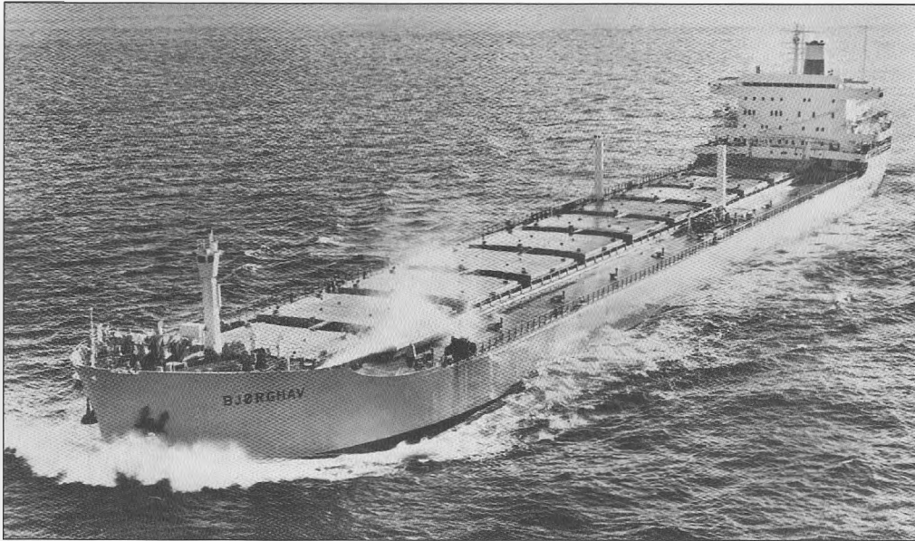
Med Bjørghav i 1967 fikk Bjørge sitt første kombinasjonsskip for olje, bulk og malm - OBO. Postkort fra rederiet
